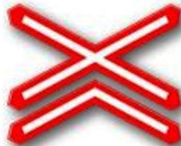
(T-27b) KONTROLSÜZ DEMİRYOLU GEÇİDİ (Çift Hat)
