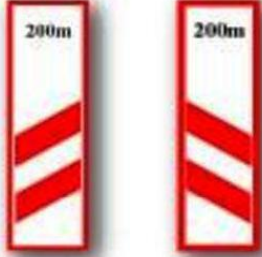
(T-29a,b) DEMİRYOLU HEMZEMİN GEÇİT YAKLAŞIMI (Sağ, Sol)
