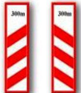
(T-28a,b) DEMİRYOLU HEMZEMİN GEÇİT YAKLAŞIMI (Sağ, Sol)
